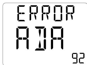
Si le code 92 est affiché, la détermination de la durée d'impulsion a échoué.
