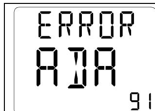
Si l'autocalibrage a échoué, l'une des erreurs correspondantes est brièvement affichée sur l'écran.
